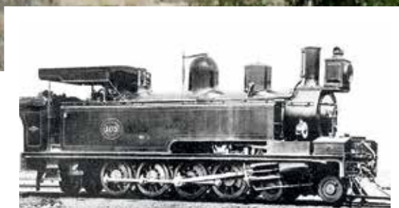
Parní lokomotiva typu 4-8-2 vznikla pro provoz v jižní Africe.
